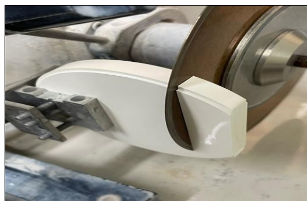
Fig 21: Isomet blade cutting bruxzir anterior blank
